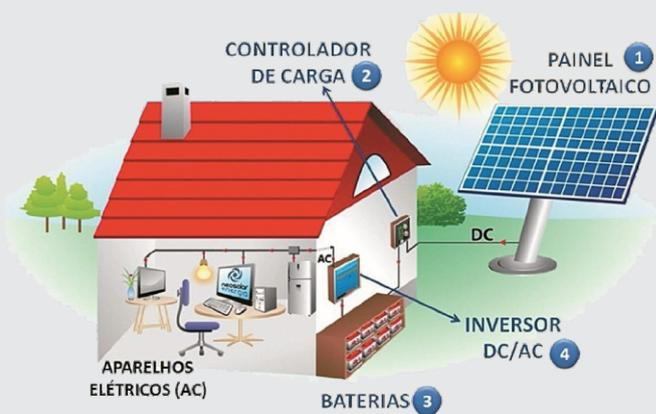
Um sistema fotovoltaico puro é aquele que não possui outra forma de geração de eletricidade. Devido ao fato de o sistema só gerar eletricidade nas horas de sol, os sistemas autônomos são dotados de acumuladores que armazenam a energia para os períodos sem sol, o que acontece todas as noites, e também nos períodos chuvosos ou nublados.
